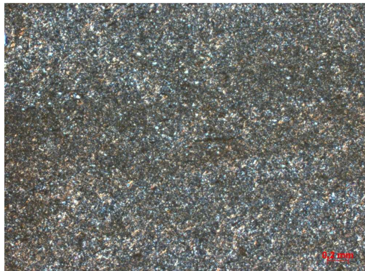
Figura 6.16: Fotomicrografia em luz polarizada representativa do argilito maciço composto predominantemente por argilominerais, quartzo e em menor proporção por muscovita. Aumento de 2,5x.
