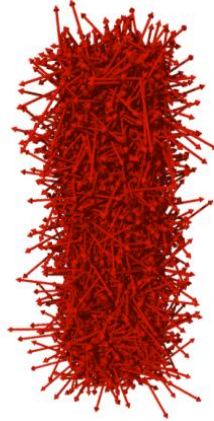
Figura 4.5. Vetores com escala aumentada em 10 vezes indicam o deslocamento dos átomos da trilha entre o dump 0 e o dump 200 do cilindro de raio r_{cyl} = 6\sigma , e temperatura T^* = 25 . Evidencia-se a aleatoriedade das direções das velocidades das moléculas da trilha.
