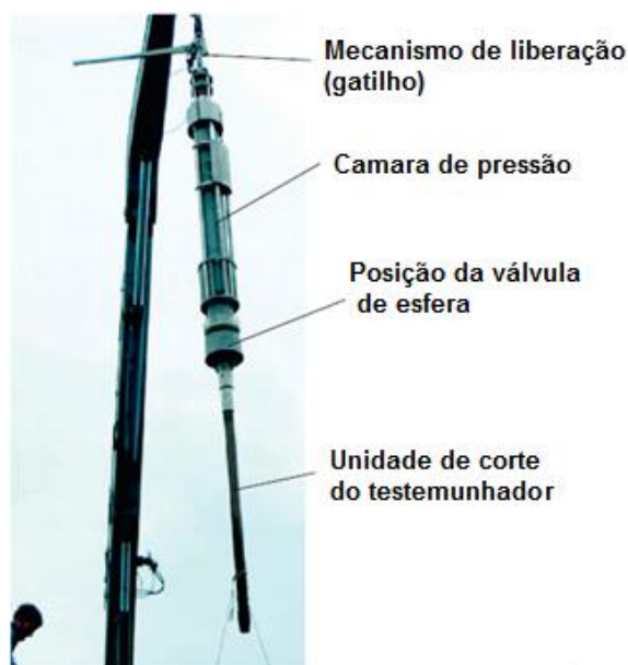
Figura 3.2.d. Testemunhador a pistão para sedimentos marinhos com sistema de preservação da pressão in situ . Créditos da imagem: (Abegg et al. 2008).
