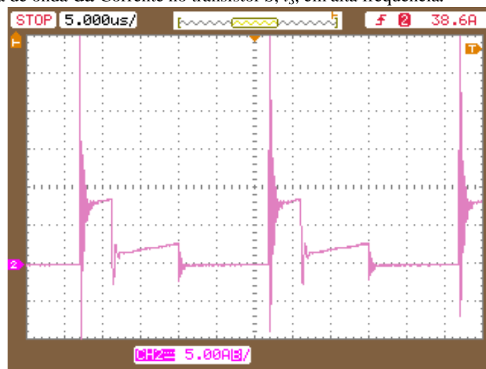
Figura 119 – Forma de onda da Corrente no transistor S , i_S , em alta frequência.
