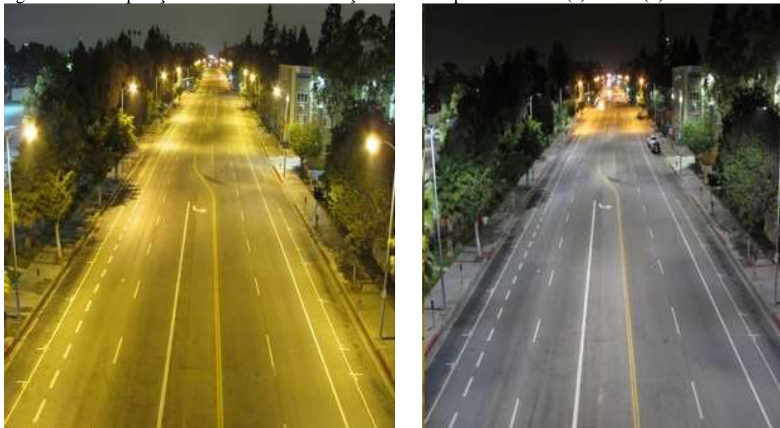
Figura 26 – Comparação visual entre a iluminação fornecida por luminárias (a) HPS e (b) LEDs.
