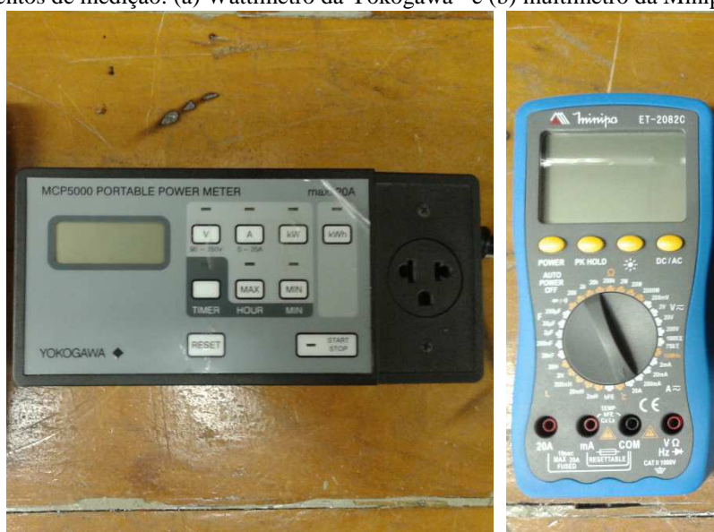
Figura 126 – Instrumentos de medição: (a) Wattímetro da Yokogawa ® e (b) multímetro da Minipa ® .
