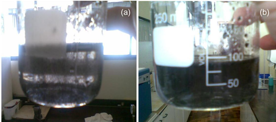
Figura 4. 2 Dispersão das nonolâminas de grafite: (a) antes do ultrassom (b) após 1 hora de ultrassom.
