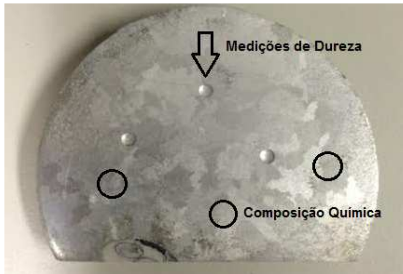
Figura 4.7. Seção transversal de corte do lingote, indicando o local de medição de dureza e determinação da composição química para cada termopar (Autoria própria).
