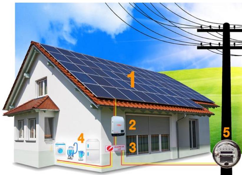
Figura 2.15 – Sistema de geração distribuída
