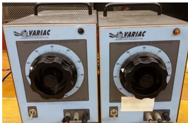
Figura 7.8 – Variadores de tensão monofásico (VARIAC).
