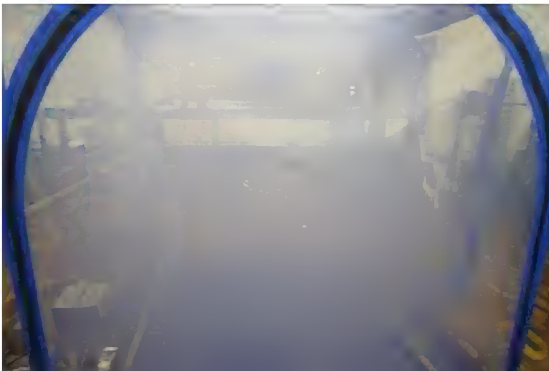
Figura 85 - Teste do sistema de homogeneização utilizando gelo seco
