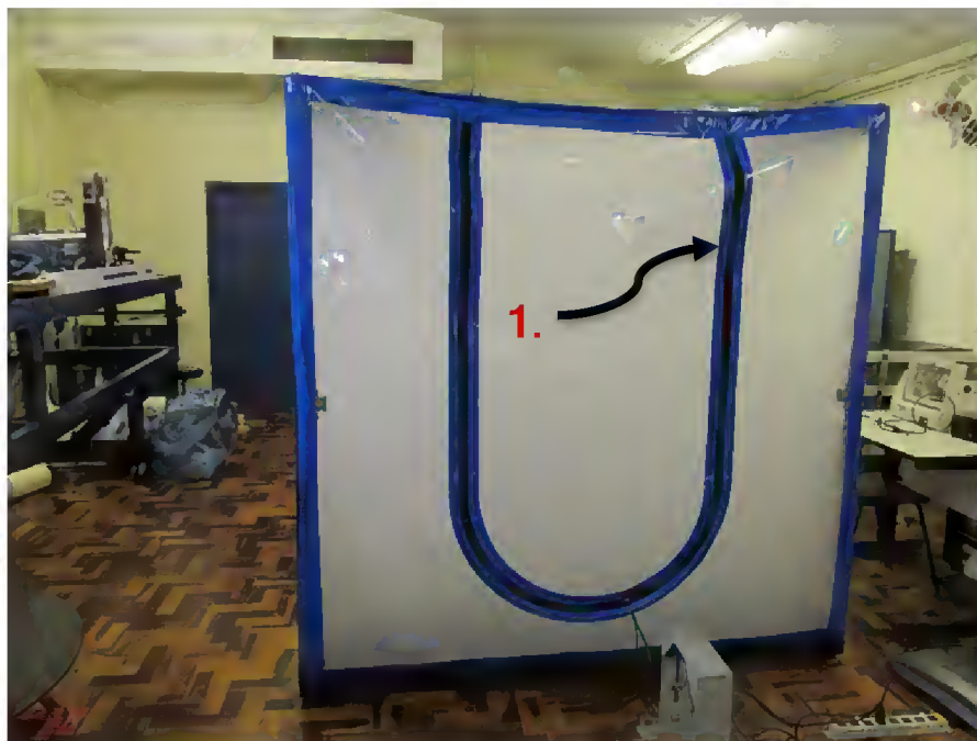
Figura 75 - Teste de vazamento - vista frontal da CNH-ERC
