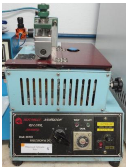
Figura 4.3. Máquina de rolo para aplicação dos adesivos HMPSA 1 e HMPSA 2.
