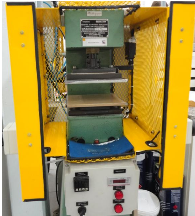
Figura 4.4. Prensa quente para colagem dos adesivos PU A, PU B e PU C.
