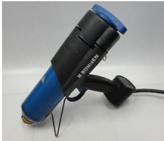
Figura 4.2. Pistola de aplicação dos adesivos PA e EVA.
