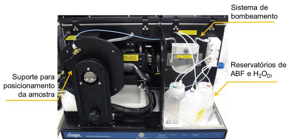
Figura 4.5. Equipamento *Wafer Profiler CVP21*, utilizado para a medição do perfil de dopagem.
