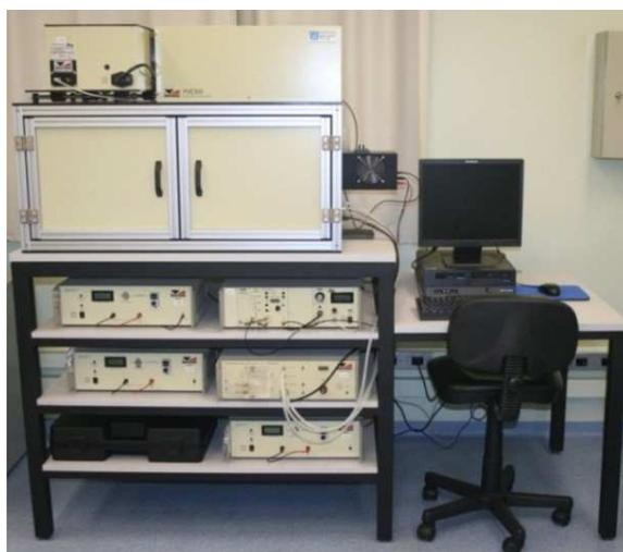
Figura 4.10. Equipamento *Bentham* PVE300, utilizado para medição da resposta espectral.
