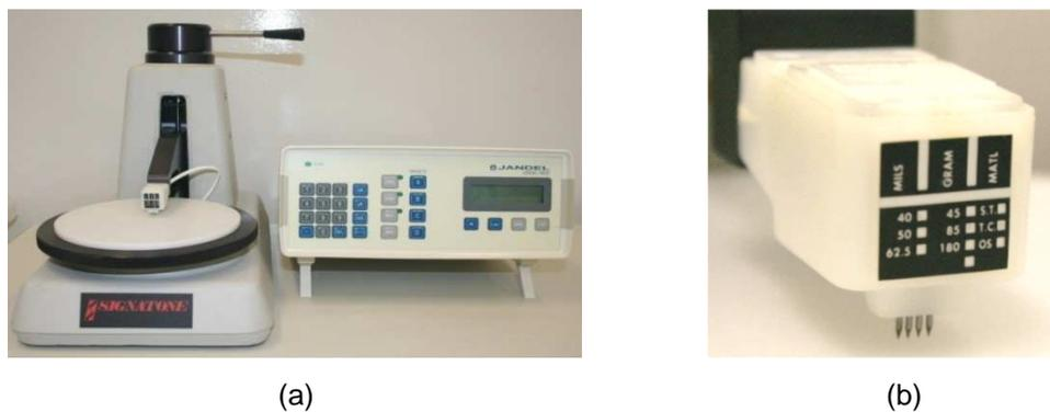
Figura 4.4. (a) Equipamento para medição da  $R_{\square}$  pela técnica de quatro pontas e (b) detalhe do cabeçote com as quatro pontas.
