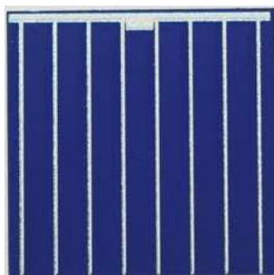
Figura 6.11. Célula solar de área 4,18 cm<sup>2</sup> com emissores seletivos e metalização da face frontal com a pasta de Ag/Al PV202. Escala 2:1.
