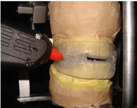
Figura 6. União das placas com cola quente
