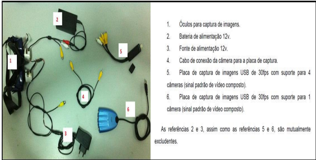
Figura 6 - Hardware do instrumento videonistagmoscopia digital
