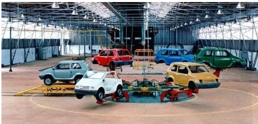
Figura 31: Rotomaq, linha de montagem circular da Gurgel. Fonte: Site Bigórnica
