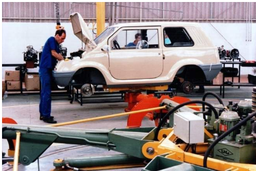
Figura 32: Rotomaq, linha de montagem circular da Gurgel. Fonte: Site Bigórnia
