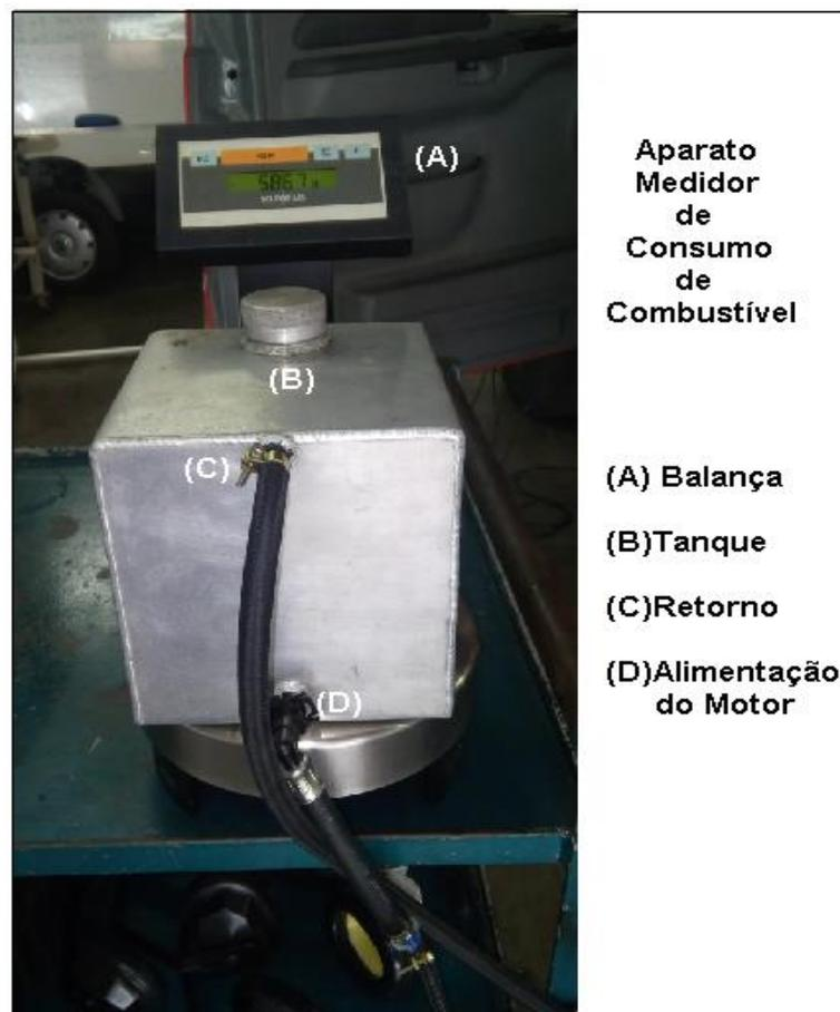
Figura 4.2. Aparato medidor de combustível.
