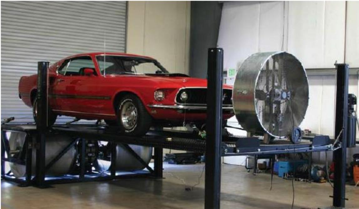
Figura 3.5. Exemplo de utilização de teste de performance de um veículo Ford Mustang em um dinamômetro de chassi (BETTES,2010).
