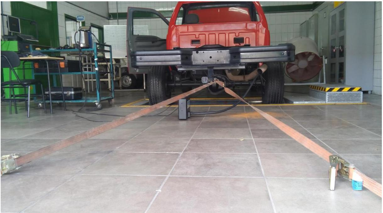
Figura 4.8. Ancoramento do veículo através de cinta no dinamômetro.
