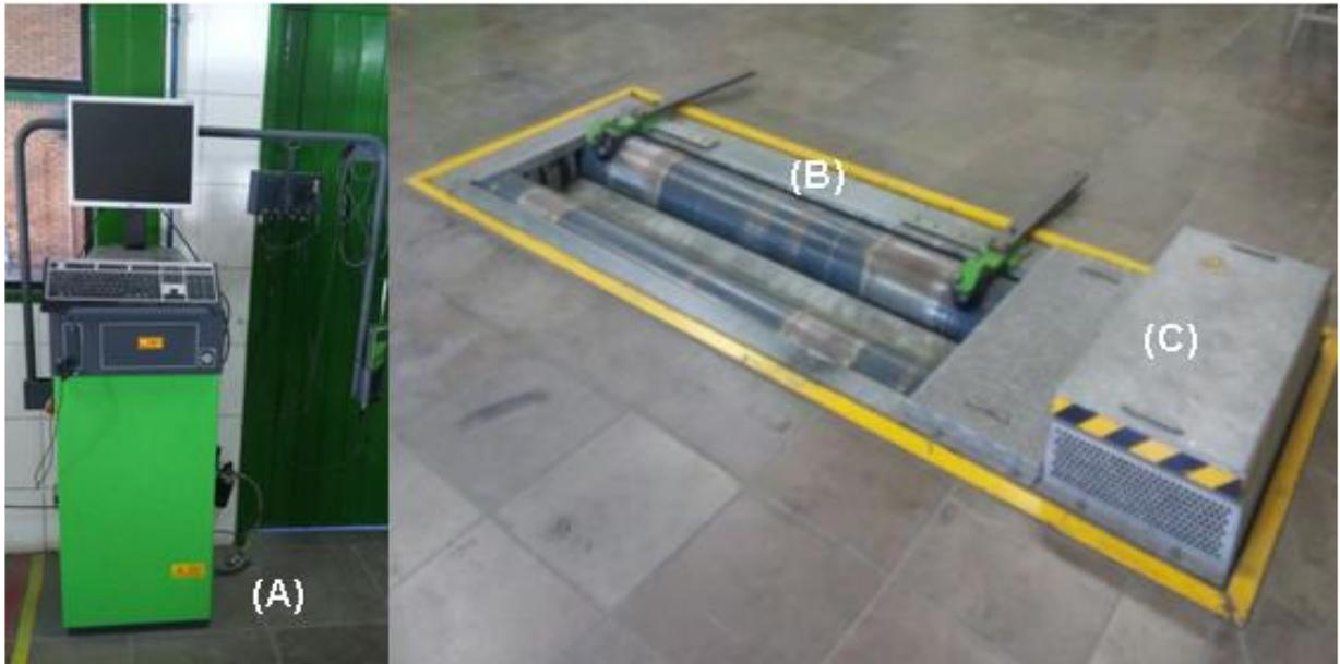
Figura 4.4. Dinamômetro de chassi Bosch FLA 203 do SENAI AUTOMOTIVO PORTO ALEGRE.
